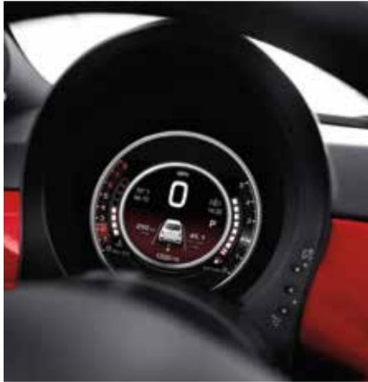
La pantalla de transistor de película delgada (TFT) de 7 pulgadas disponible muestra con claridad la velocidad, el rendimiento de combustible, la autonomía de manejo y mucho más.
