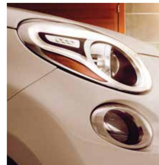
*Los faros delanteros halógenos de tipo proyector bifuncionales le permiten ver y ser visto con poca o ninguna iluminación.*
